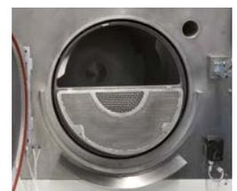
Il cestello é intercambiabile per poter scegliere il diametro dei fori, realizzato su misura in base alle vostre esigenze. Il caricamento dei pezzi avviene manualmente attraverso la porta esterna. Lo svuotamento del cestello avviene automaticamente con l'ausilio di listelli per il rotolamento che si trovano all'interno dello stesso.
