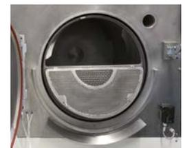
Il cestello è intercambiabile per poter scegliere il diametro dei fori, realizzato su misura in base alle vostre esigenze. Il caricamento dei pezzi avviene manualmente attraverso la porta esterna. Lo svuotamento del cestello avviene automaticamente con l'ausilio di listelli per il rotolamento che si trovano all'interno dello stesso.
